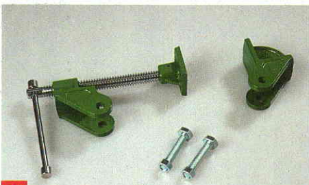
4 Die Leistenspanner sind überaus universell als Klemm- und Spreizelemente verwendbar. Mit M10er Schrauben ...
